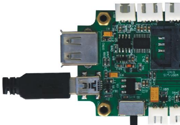
图 1-3 将英创嵌入式模块通过 USB-OTG 连接到开发主机 (EM9283 手持设备开发评估底板)
