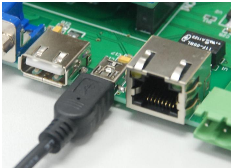
图 1-2 将英创嵌入式模块通过 USB-OTG 连接到开发主机
